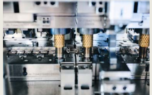
ステップ 1 プラグ接点の材料は、必要に応じて打ち抜かれ、成形されます。
