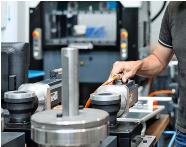
プログラム可能な回転ステーションにより、さまざまな形状の積層スタックを製造できます。
