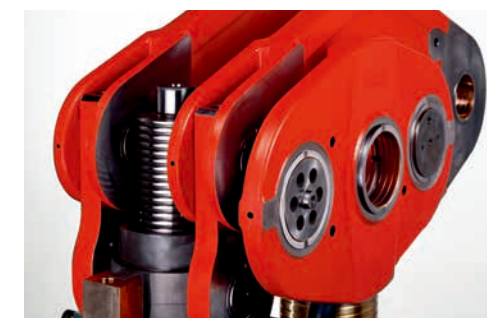
生産稼働中でのラム高さ調整
